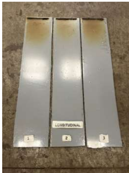
PHOTOGRAPHIE n° 2 : Aspect de la zone affectée par le rayonnement des 3 échantillons testés.
