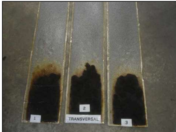
Photo n° 3 : Aspect de la zone affectée par le rayonnement des 3 échantillons testés
