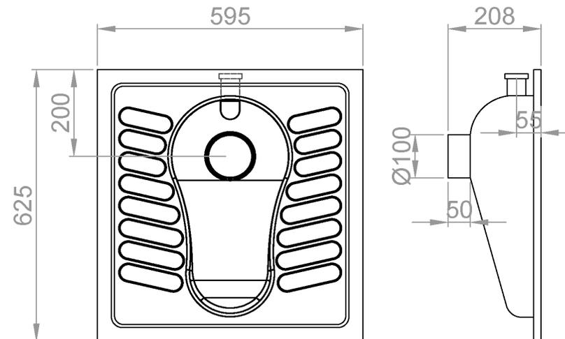
**TOILETTE TURQUE DE SOL ANTI-VANDALISME AVEC BUSE DE PULVÉRISATION AVEC TROIS SORTIES D'EAU. ÉPAISSEUR DE 1,2 MM. ACIER INOXYDABLE. FINITION BRILLANTE.**
