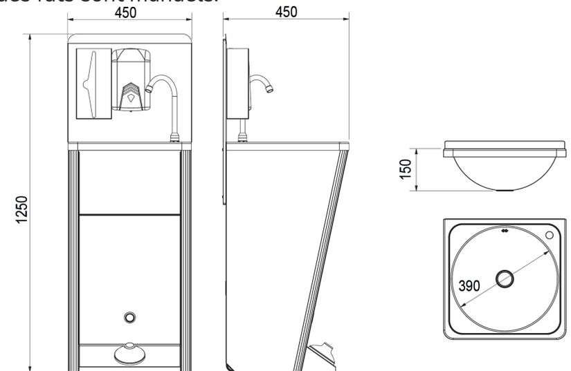
Lave-mains portable autonome avec bouton poussoir hydraulique.
